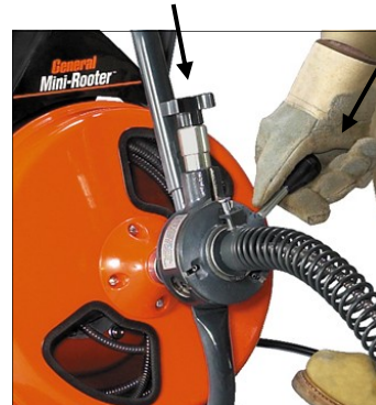
Bouton de réglage de la pression d'alimentation
